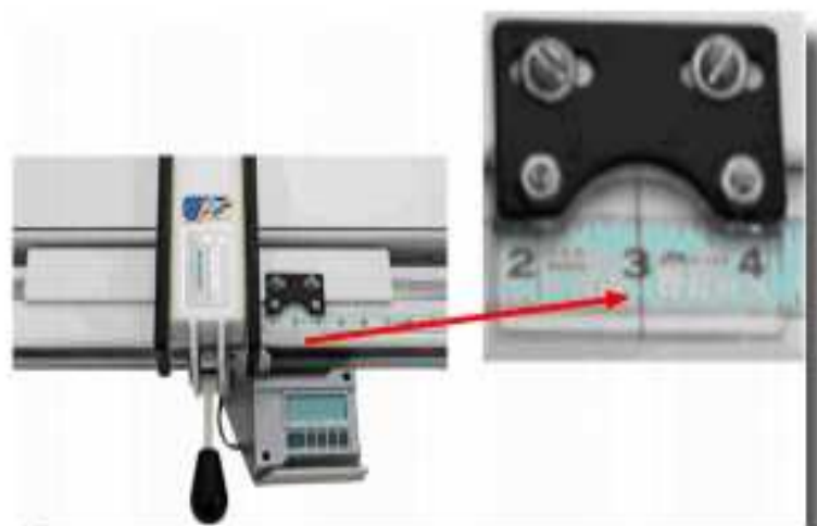
▲ ภาพที่ 6 การสอบเทียบไม้บรรทัดเหล็กด้วยอิเล็กทรอนิกส์สเกล
